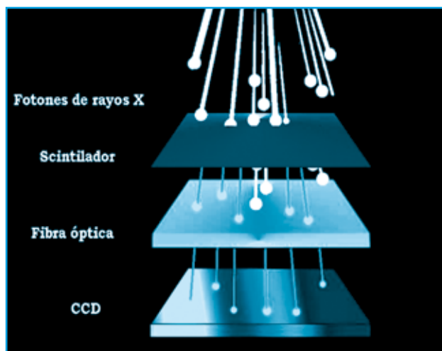
Figura 2. Esquema de la configuración interna de los sensores de RadioVisioGrafía de la firma Trophy (Francia). Se observa cómo el scintilador convierte los rayos X en luz visible y la fibra óptica actúa como filtro, permitiendo sólo el paso de la luz hacia el CCD. (Fuente: Horner K. RadioVisioGraphy: an initial revolution. Br Dent J 1990; 168: 244 – 8.)
